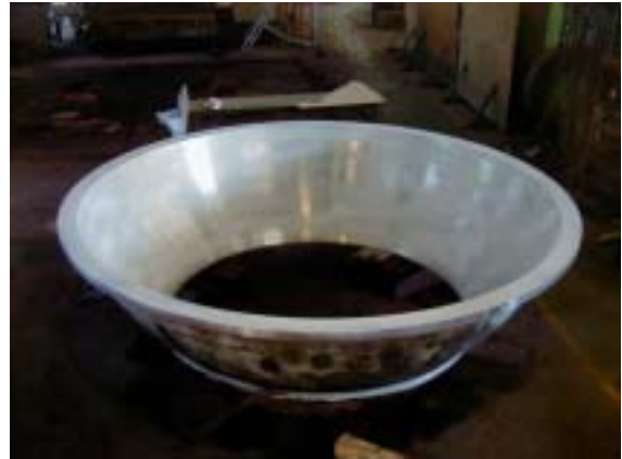
品名：プロテクトライナー 重量：1,530 Kg ( 2,860 ) 材質：SCS13
