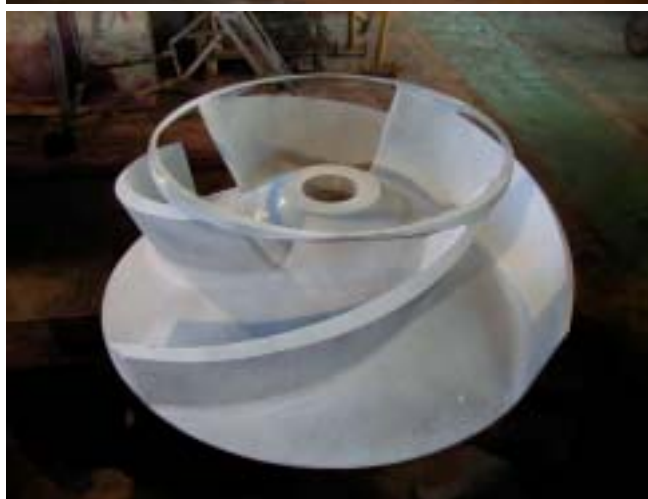
品名：インペラー 重量：500Kg ( 1,250) 材質：ASTM A351 CD3MWCuN
