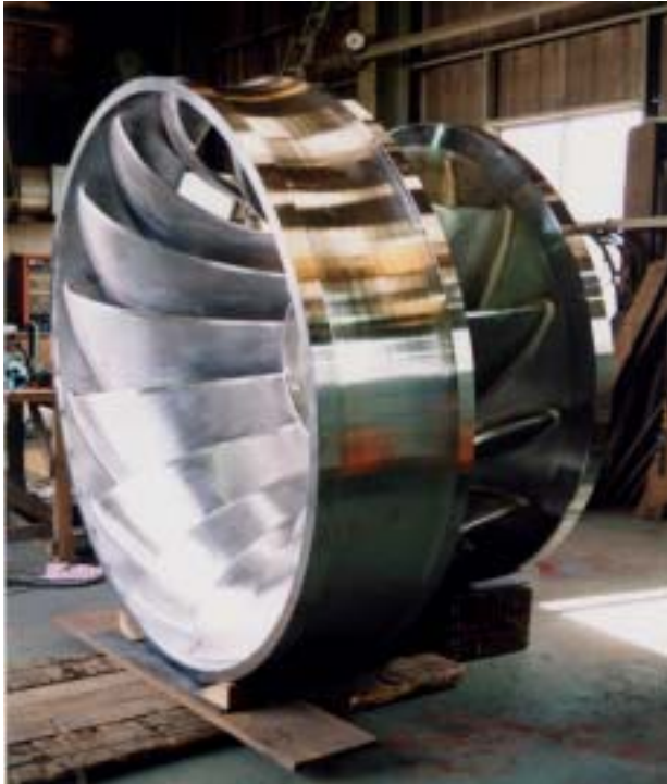
一体フランシスランナー 重量：鋳放 9,000Kg 材質：SCS6 納入先：(株)東芝 発電所：奥三面（新潟県企業局）
