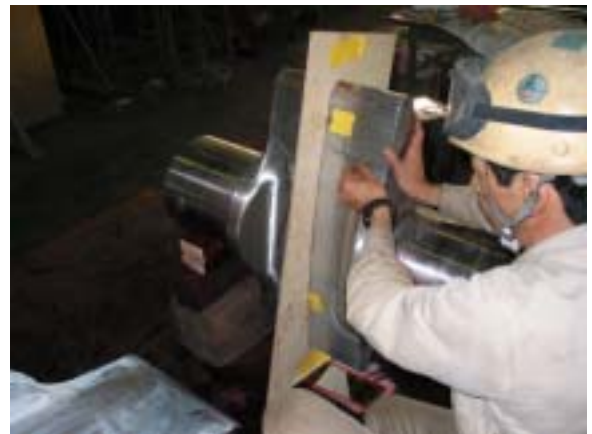
ガイドベーン 重量：1,470Kg 材質：2RM2-A 納入先：(株)日立製作所 発電所：小丸川（九州電力）
