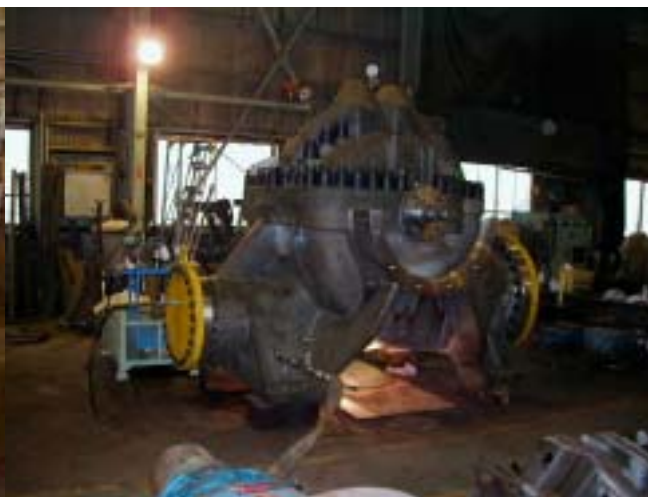
品名：渦巻ケーシング 重量：( 上部 ) 3,410 Kg ( 下部 ) 8,730Kg 材質：ASTM A351 CD4Mcu 納入先：(株)西島製作所
