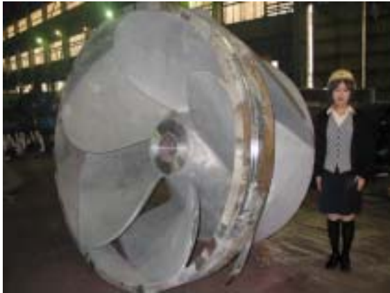
品名：インベラー 重量：3,900 Kg ( 2,392 ) 材質：SCS13
