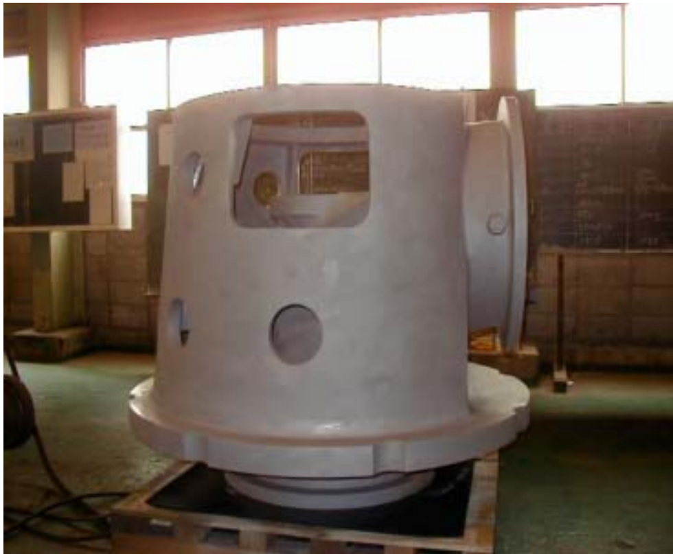
品名：吐出しエルボ(原子力用海水ポンプ部品) 重量：2,500Kg 材質：GSCS16 納入先：三菱重工(株)
